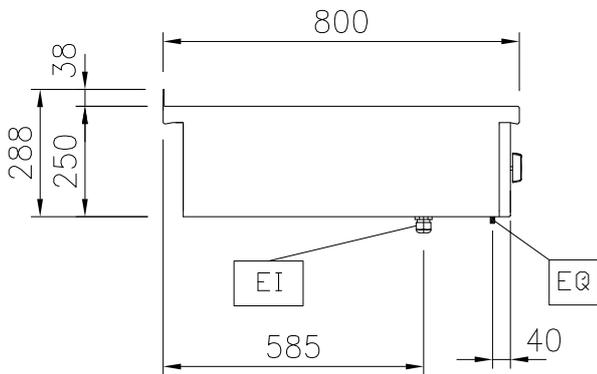
EI = Conexión eléctrica (energía)
